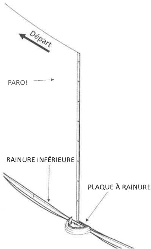
Insérez la paroi dans la rainure inférieure en commençant au centre d'une plaque. Au départ, une ou deux barres de soutien maintiennent la paroi en place. Une personne déroule la paroi sur un madrier ou une planche, tandis qu'une autre personne l'insère dans la rainure inférieure. On ne doit pas dérouler plus de 3 m (10') sans mettre en place une barre de soutien pour renforcer la structure.
