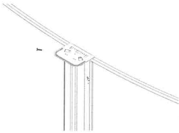
Déposez la plaque du haut sur les montants verticaux. Posez les vis à métal au haut du montant vertical en vous assurant que les montants soient perpendiculaires à la surface du sol.
