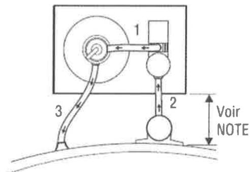
Insérez des embouts filetés, s'il y a lieu, de façon à pouvoir fixer la valve dans l'écumoire.
