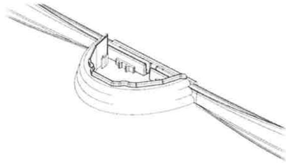
Assemblez toutes les rainures inférieures aux plaques à rainure de façon à former un cercle parfait avec un diamètre et un rayon conforme au tableau.
